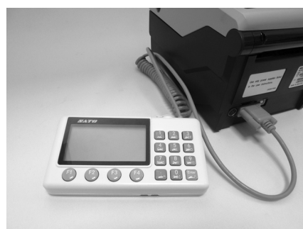
Exemple de connexion du clavier optionnel à l'imprimante.
