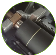
Weißer Linie auf einer neuen PureLine™-Druckplattenwalze.
