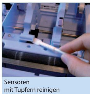
Sensoren mit Tupfern reinigen
