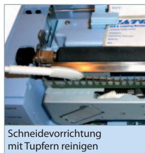
Schneidevorrichtung mit Tupfern reinigen
