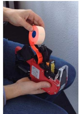
**WICHTIG:** Prüfen Sie vor dem Einlegen die ersten 15cm des Etikettenbandes auf Etikettenreste auf der Rückseite – ggf. da abreißen! Diese verkleben sonst den Etikettenschacht!
