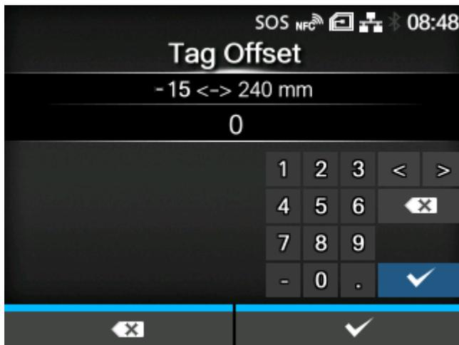
Die Position festlegen, an der das Schreiben der Daten zum Inlay starten soll. Die Daten werden an der Stelle auf ein Inlay des Tags geschrieben, an der das Inlay über die RFID-Antenne des Druckers fährt, die sich in der in dieser Einstellung angegebenen Entfernung von der Druckstartposition befindet.
