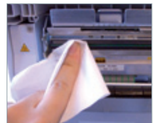
Limpié del cabezal con pañuelos
