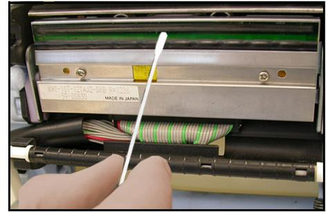
**Figura 6-2, Limpieza del cabezal de impresión**
