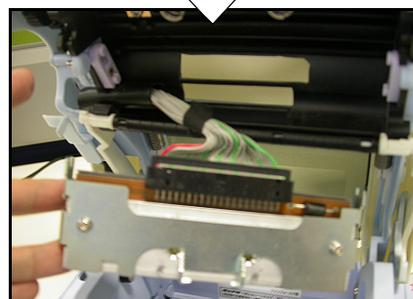
5. Vuelva a introducir el cabezal de impresión en la impresora, asegurándose de que las ranuras de metal de ambos lados del cabezal de impresión se ajustan a los pivotes púrpuras redondos de la impresora (véase a zona marcada con un círculo en la imagen).
