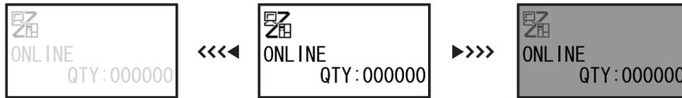
Sie können die Helligkeit in 32 Stufen anpassen (16 nach links und 16 nach rechts). Die Helligkeit ändert sich pro Druck auf die **Pfeiltaste** ◀ oder ▶ um eine Stufe.
