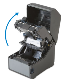
Mayor apertura de la tapa superior para cargar el soporte
