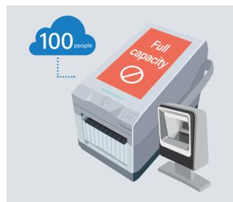
L'imprimante gère le nombre de clients dans le magasin. Si la capacité est dépassée, l'étiquette ne sera pas imprimée.
