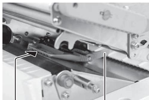
Ausrichten des Durchlichtsensors (mit einem Dreieck markiert) auf die Lochstanzung des eingeführten Druckmaterials.
