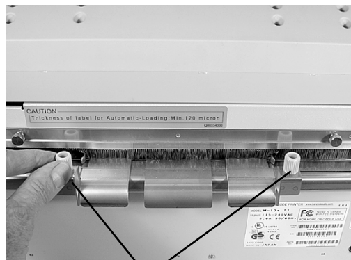
Ρικνωτές βίδες για τη ρύθμιση του πλάτους του χαρτιού των ετικετών
