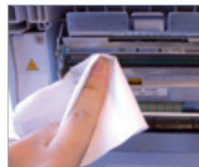
Reinig de printkop met tissues
