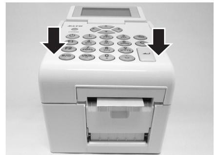
6. Tras cargar las etiquetas, pulse el botón de encendido
