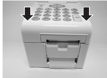
6. Tras cargar las etiquetas, pulse el botón de alimentación
