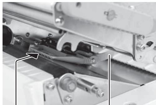
Alignez la position de la cellule de détection d'échenillage/perforations vignette (repérée d'un triangle) vers le côté perforation (centrale/latérale) du support chargé.
