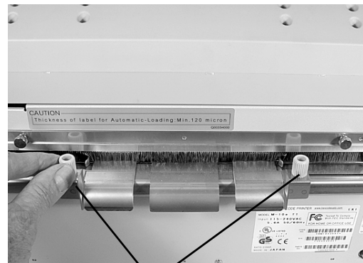
Siipiruuvit etikettileveyden säätöä varten
