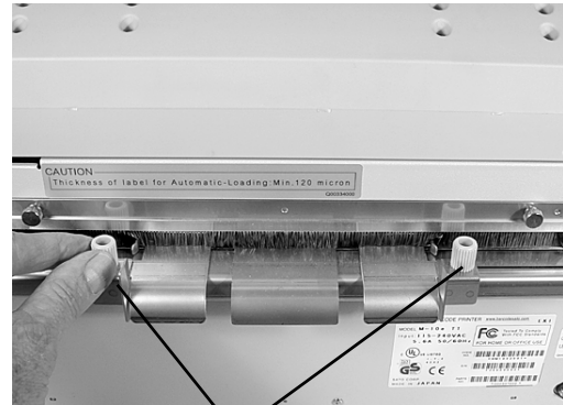
Parafusos de orelhas para regulação da largura da etiqueta
