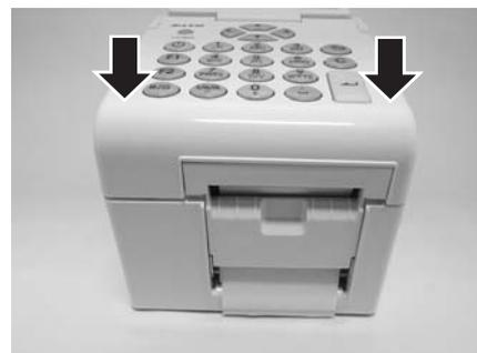
6. Une fois les étiquettes chargées, appuyez sur le bouton
