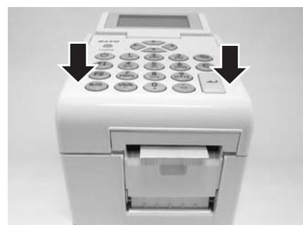
6. Une fois le support chargé, appuyez sur le bouton
