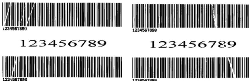
Une fois que des impressions telles que celles ci-dessus apparaissent, cela pourrait provenir de positions inégales de la fixation du ruban, qui doit être ajustée correctement pour que ses hauteurs soient égales des deux côtés. Les étapes de réglage sont les suivantes :
