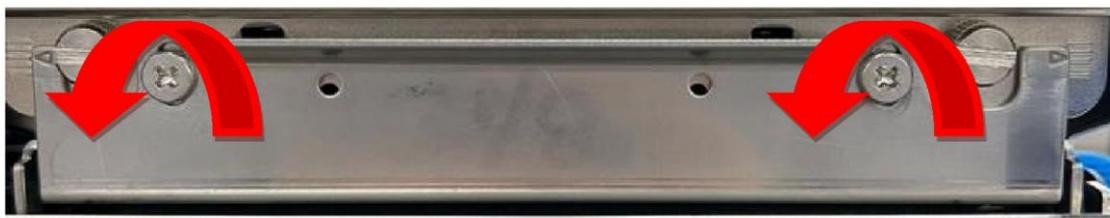
2. Assurez-vous d'abord que la fixation du ruban est dans sa position la **plus basse**, puis serrez les vis en les tournant dans le sens des aiguilles d'une montre.
