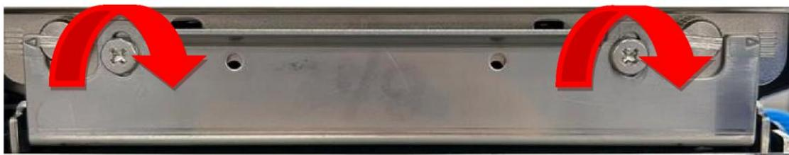
3. Ou bien réduisez l'apparition de plis de ruban, en utilisant le mécanisme de réglage de froissement du ruban aux deux extrémités.
