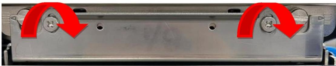
3. Alternativ kann das Auftreten von Farbbandfalten durch den Mechanismus zur Faltenvermeidung an beiden Enden reduziert werden.
