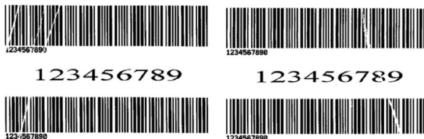
Sobald solche Ausdrücke wie oben erscheinen, kann die Ursache eine ungleichmäßige Positionierung der Farbbandhalterung sein, die richtig justiert werden muss, sodass beide Seiten die gleiche Höhe aufweisen. Die Anpassungsschritte sind wie folgt:
