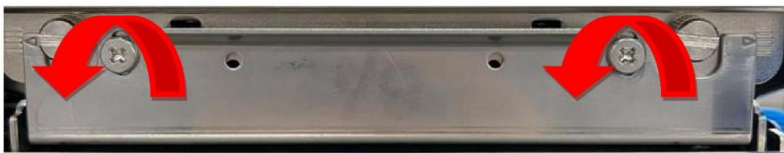
2. Stellen Sie sicher, dass sich die Farbbandhalterung zunächst in der untersten Position befindet; ziehen Sie dann die Schrauben im Uhrzeigersinn fest.
