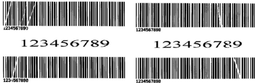
Qualora si presentino stampe come sopra, la causa potrebbe risiedere in un posizionamento non uniforme della staffa del nastro. È necessario regolarla accuratamente per uniformarne l'altezza su entrambi i lati. Segue la procedura di regolazione:
