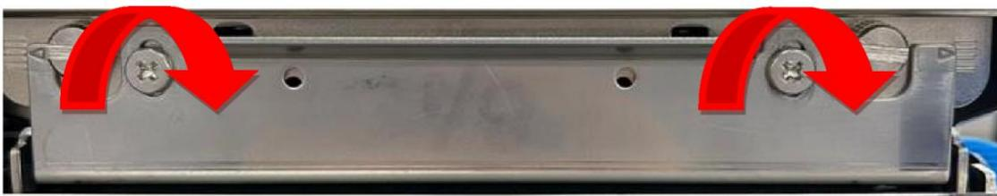
3. In alternativa, ridurre la formazione di pieghe del nastro utilizzando il meccanismo di regolazione anti-piega presente su entrambi i lati.
