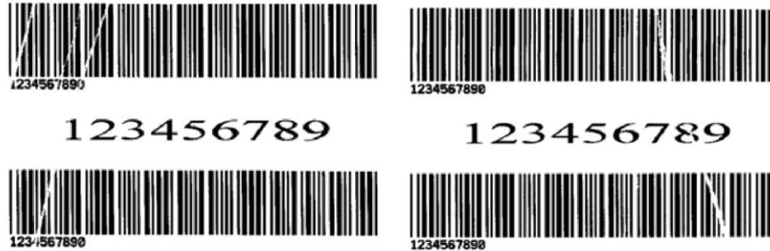
Una vez que aparezcan las impresiones como se muestra arriba, la posible causa puede ser la posición desigual del soporte de la cinta, lo cual necesita ser ajustado adecuadamente para que sus alturas sean iguales en ambos lados. Los pasos para ajustar son los siguientes:
