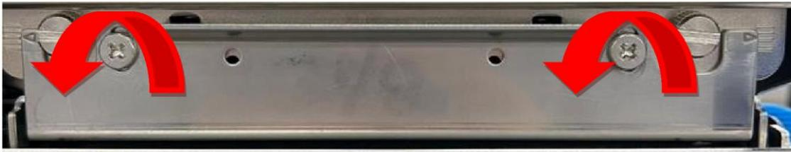
2. Asegúrate de que el soporte de la cinta esté en su posición **más baja** primero; luego aprieta los tornillos girando en el sentido de las agujas del reloj.
