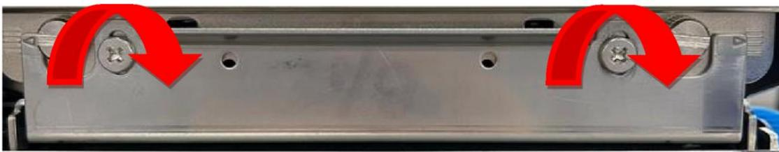
3. Alternativamente, por favor reduce la aparición de arrugas en la cinta mediante el mecanismo de ajuste de arrugas en ambos extremos.
