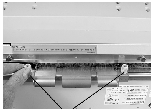
Vleugelschroeven voor het regelen van de etikettenbreedte
