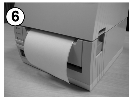
6 Refermez le capot. Vous pouvez imprimer maintenant par impression thermique.
