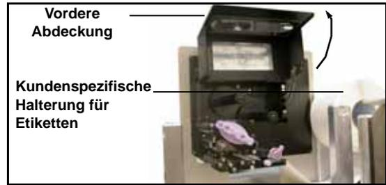
2. Lösen Sie den violetten Hebel der Kopfverriegelung, indem Sie ihn nach unten drücken. Die Druckkopfvorrichtung hebt sich und erlaubt so das Einlegen der Etikettenrolle.
