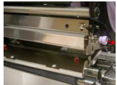
4. Ziehen den Druckkopf raus und entfernen Sie die beiden Halterungen, die an ihm befestigt sind.
