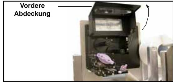
2. Ziehen Sie den violetten Hebel der Kopfverriegelung entgegen des Uhrzeigersinn nach oben. Die Druckkopfeinheit hebt sich und erlaubt so das Einlegen des Farbbandes.
