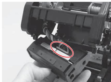
6. Collegare con prudenza una **testina di stampa** sostitutiva al **connettore del cavo**. Il connettore è codificato, ovvero può essere collegato solo se orientato correttamente.
