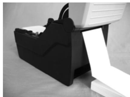
3. Tenendo premuta la **leva di scorrimento della guida**, regolare la larghezza del **supporto materiale di stampa** ① in base al formato del materiale di stampa. Dopo aver estratto il materiale da stampa, fare passare il materiale attraverso le **guide del materiale da stampa** e posizionare il bordo anteriore del materiale sopra i **rulli di stampa**.
