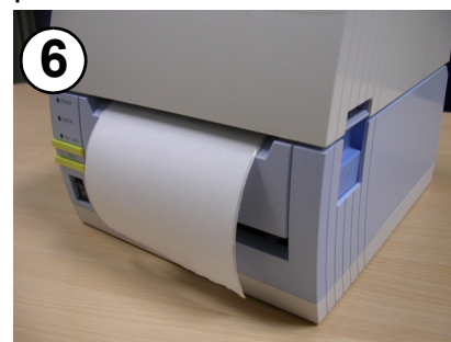
6 Chiudere il coperchio. La stampa termica diretta è ora possibile.
