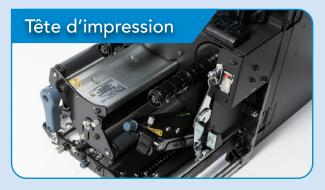
Mécanisme d'impression en aluminium moulé (au lieu de plaques soudées), pour plus de robustesse.
