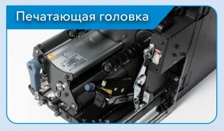
Штампованный алюминиевый каркас механизма печати (вместо сварных панелей) для дополнительной прочности.
